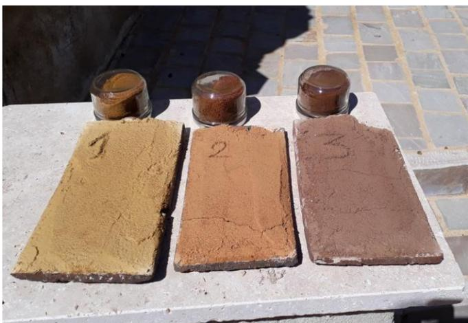
*Essais d'enduits frais à la chaux incorporant du sable local dit « du Perche » ou « sable d'or », faisant ressortir des ocres chaleureux.*
